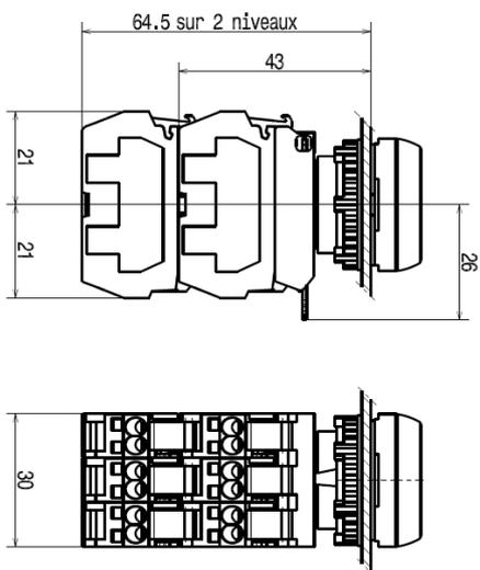
Блоки с пружинными клеммами с монтажным адаптером, 5 постов
