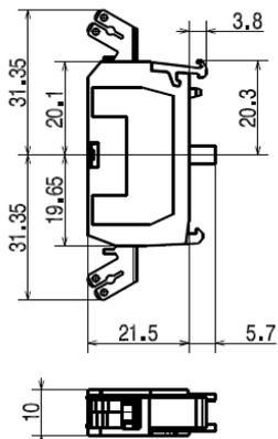
Контактные блоки с контактными выводами под пайку
