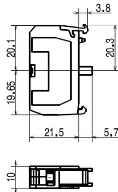
Контактные блоки с пружинными клеммами
