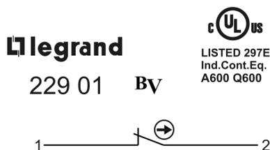
. Маркировка задней панели встроенного блока НЗ
