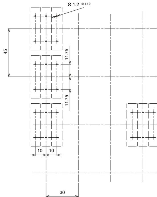
Контактные блоки с зажимами под винт
