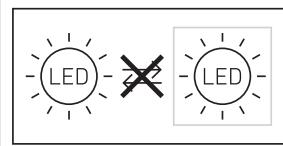
Подключение к сумеречному освещению ведет к повреждению сенсорного светильника.
